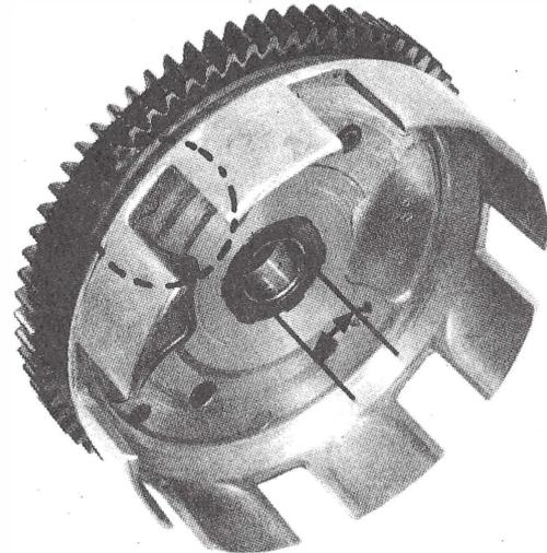
**BALANCER IDLER GEAR/OIL PUMP DRIVEN GEAR REMOVAL**
