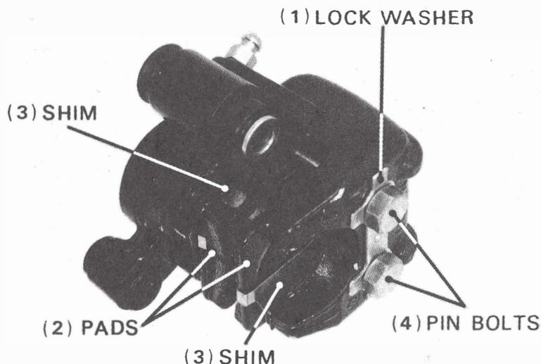
**BRAKE CALIPER INSTALLATION**
