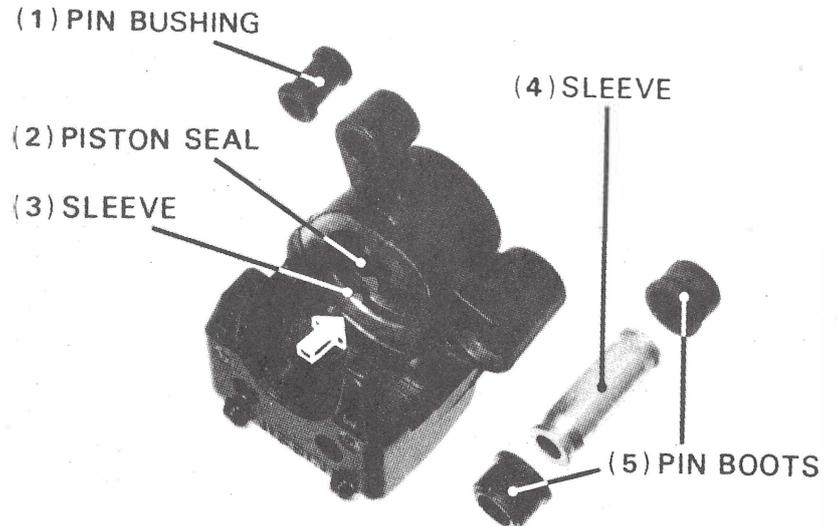
**CALIPER CYLINDER INSPECTION**
