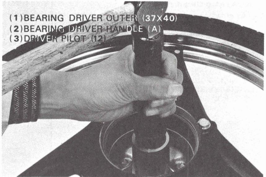
**FINAL DRIVEN SPROCKET INSTALLATION**
